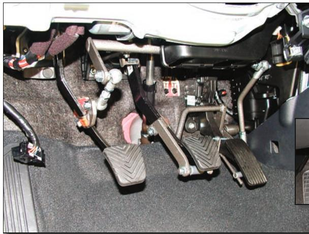
Toto zařízení zajišťuje bezpečné a nezávislé ovládání spojky, brzdy a plynu ve vozech autoškoly z místa spolujezdce.
